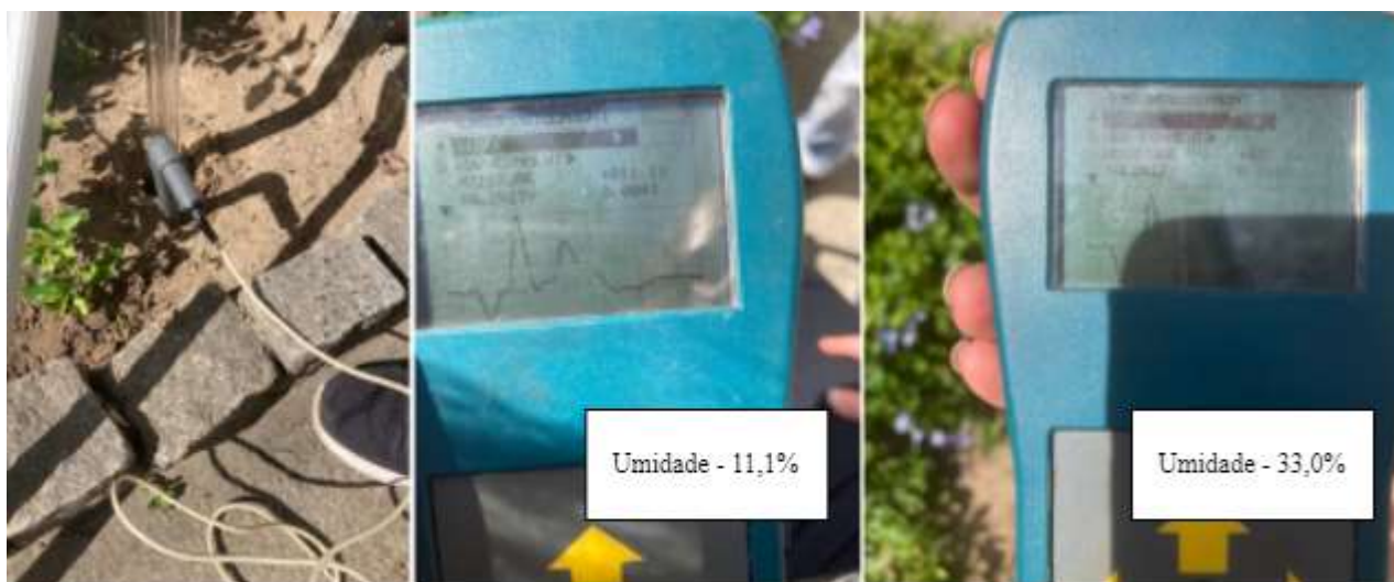
Figura 19 - Medição de umidade do solo anterior e após o ensaio com o permeâmetro de Guelph
