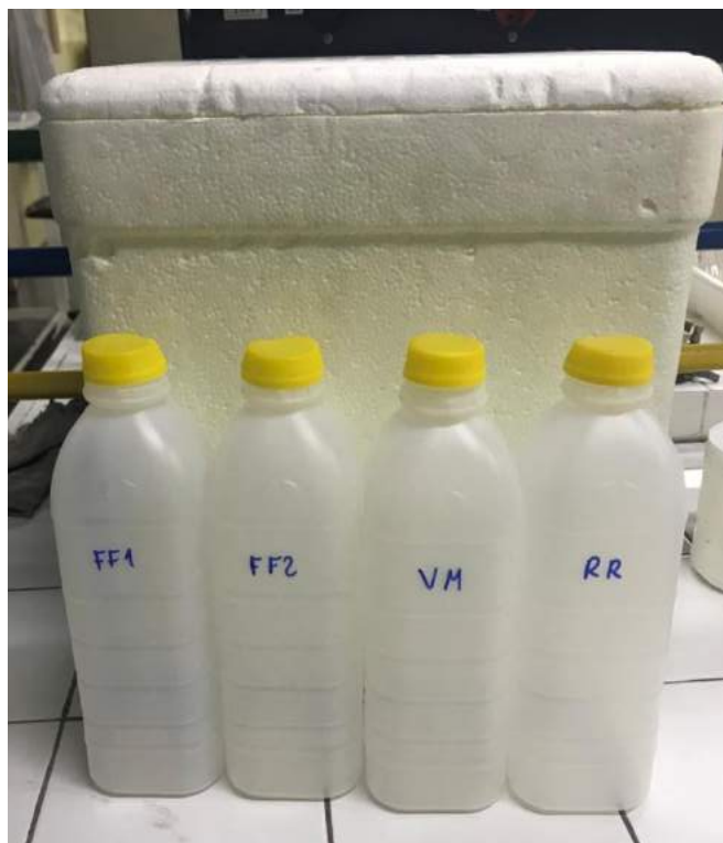
Figura 14: Preparo do material de coleta e identificação dos pontos de amostragem de água de chuva do first flush primário (FF1), first flush secundário (FF2), volume morto (VM) e reservatório (RR).
