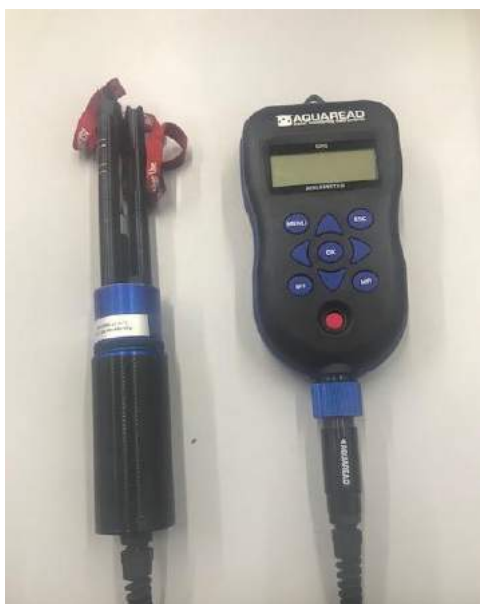
Figura 18: Sonda Multiparâmetro Aquaread AP-700 de monitoramento de qualidade de água.
