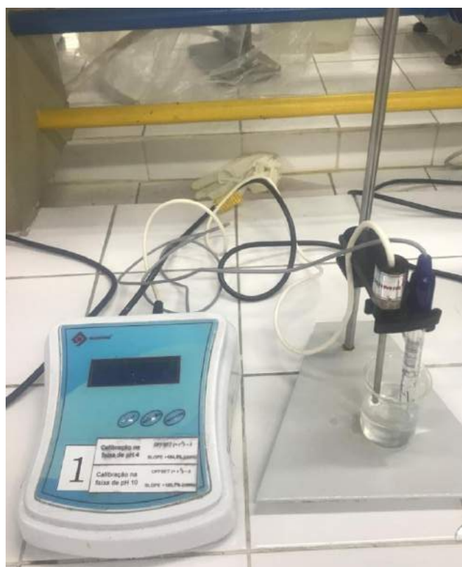
Figura 16: Aparelho pHmetro utilizado nas análises de amostras de água de chuva.
