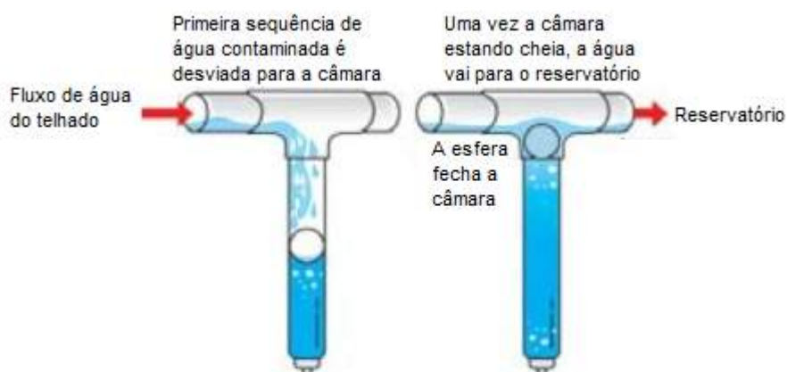
Figura 13: Exemplo 2 de dispositivo de descarte da primeira chuva Fonte: SELO CASA AZUL, 2010
