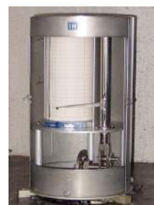
Figura 6 - Linígrafo de Bóia Convencional
