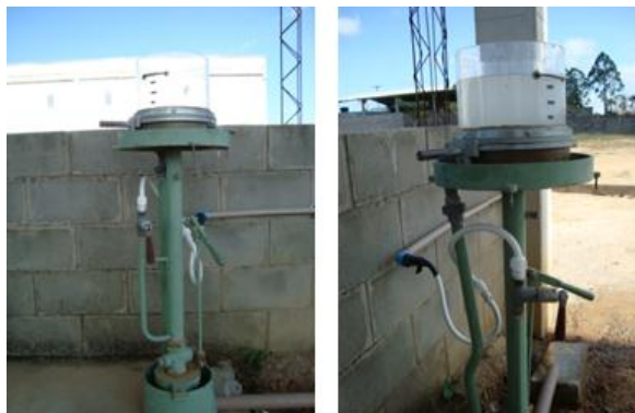
Figura 2: Formador de folha circular a vácuo.
