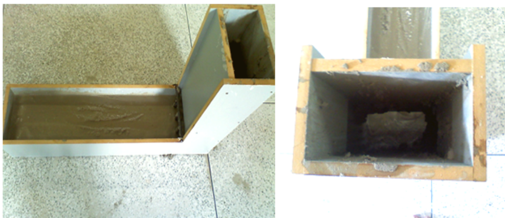
Figura 10 – Vistas do experimento de caixa em L realizado
