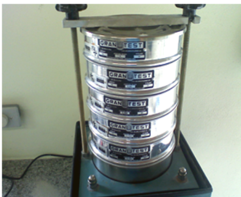
FIGURA 2 – Sistema de peneiras para determinação da distribuição granulométrica.
