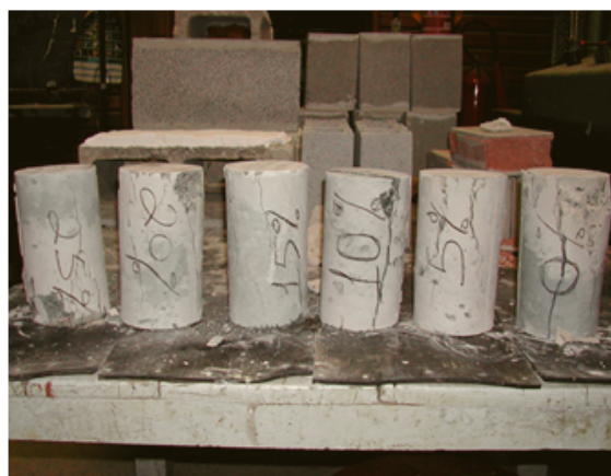
Figura 9 – Corpos de prova após o teste de resistência
