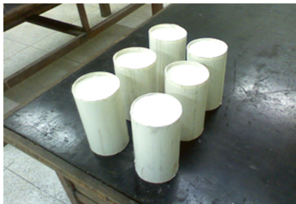
Figura 3 – Moldes para confecção dos corpos de prova
