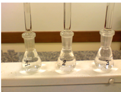
FIGURA 1 – Picnômetros utilizados para determinação da densidade do sólido.
