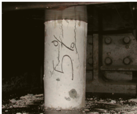
Figura 8 – Teste de resistência para o corpo de prova com 5% de resíduos
