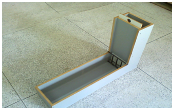
Figura 5 – Equipamento em Caixa em L
