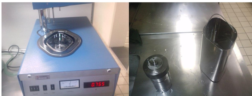
Figura 2 – Calorímetro isotérmico IKA C4000
